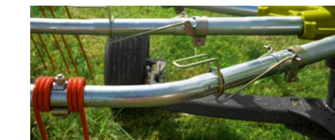
Bezpieczeństwo w razie kolizji: ramiona zginają się w wyznaczonym miejscu.
