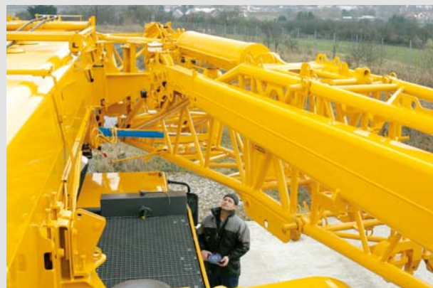
Dispositivo idraulico per il montaggio del falcone con Bluetooth Terminal
