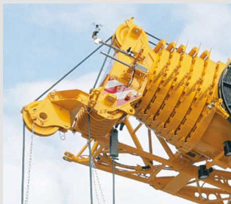
Puleggia aggiuntiva testa braccio ripiegabile lateralmente
