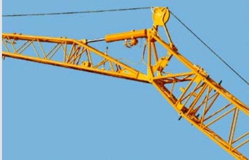
Falcone regolabile idraulicamente (0°-40°)
