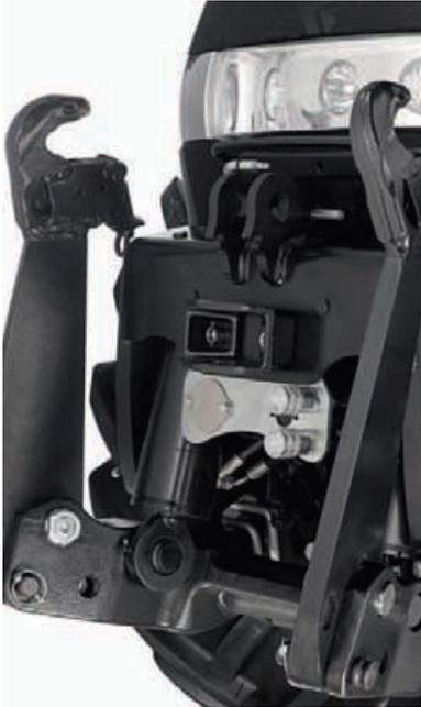
Voll integrierte Fronthydraulik mit einer Hubkraft von 5.000 kg.
