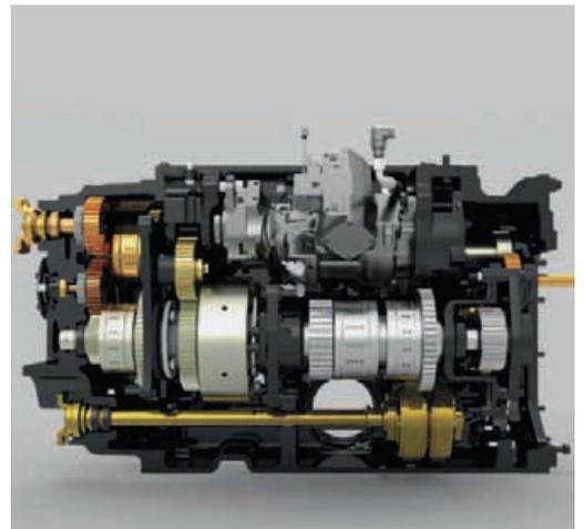
CVX-Getriebe – stufenlos von 0 bis 50 km/h.
