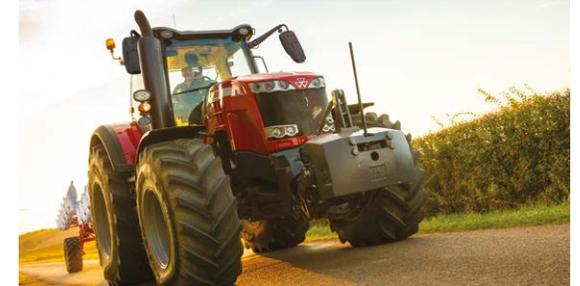
Die intelligente Bauweise des geschwungenen Rahmens und des integrierten Fronthubwerks ermöglichen eine exzellente Wendigkeit und große Lenkeinschläge.
