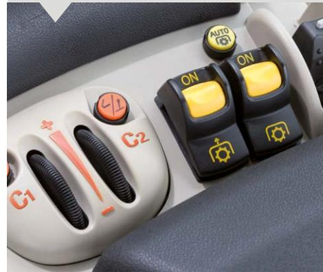
An den Kotflügeln verfügbare Bedientasten für Zapfwelle, Hydraulik-Steuerventil und Hubwerk.
