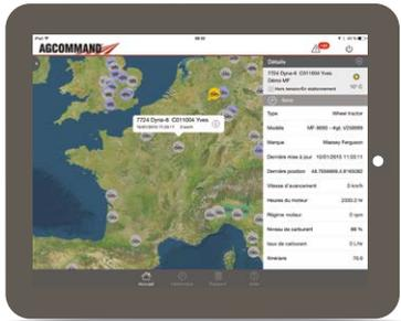
**Fahrtverlaufskarten:** Zeigen Sie auf einer Google-Karte oder einem Satellitenbild an, wo sich der Traktor während einer bestimmten Zeitspanne befand, mit Informationen zu Stopps, Arbeitsvorgängen sowie Start- und Zielpunkt. AgCommand® Advanced kann die über den CAN-Bus der Maschine gesammelten Daten wie Motorlast, Radschlupf und Kraftstoffverbrauch anzeigen. Darüber hinaus bietet es die ultimative Nachverfolgbarkeit der Maschine.
