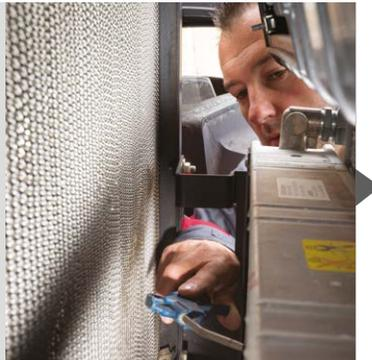
Die kompakte Kühleinheit ist bequem zugänglich und einfach zu reinigen und zu warten. Durch die Saugwirkung der Kühlgebläse wird der Staub zu 90 % auf natürliche Weise entfernt. Auch der Luftfilter des Motors ist bequem zugänglich und leicht zu reinigen.
