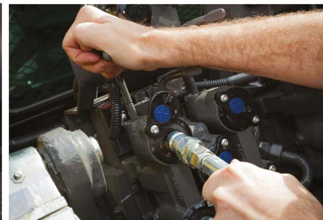
Alle Heckkupplungen sind mit hydraulischer Druckentlastung ausgestattet.
