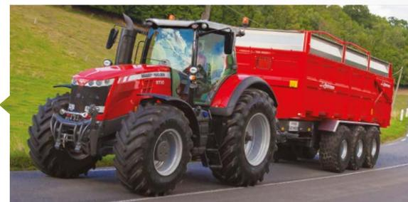
**Mehr Sicherheit auf der Straße.** Alle Traktoren der Baureihe MF 8700 sind serienmäßig mit Druckluftbremsanlagen für die Anhänger ausgestattet, einschließlich einem optionalen ABS-Signal für Anhänger für ultimative Sicherheit. Ein neuer Sensor am Bremspedal sorgt für mehr Sicherheit für Traktoren, die mit mehr als 40 km/h unterwegs sind.
