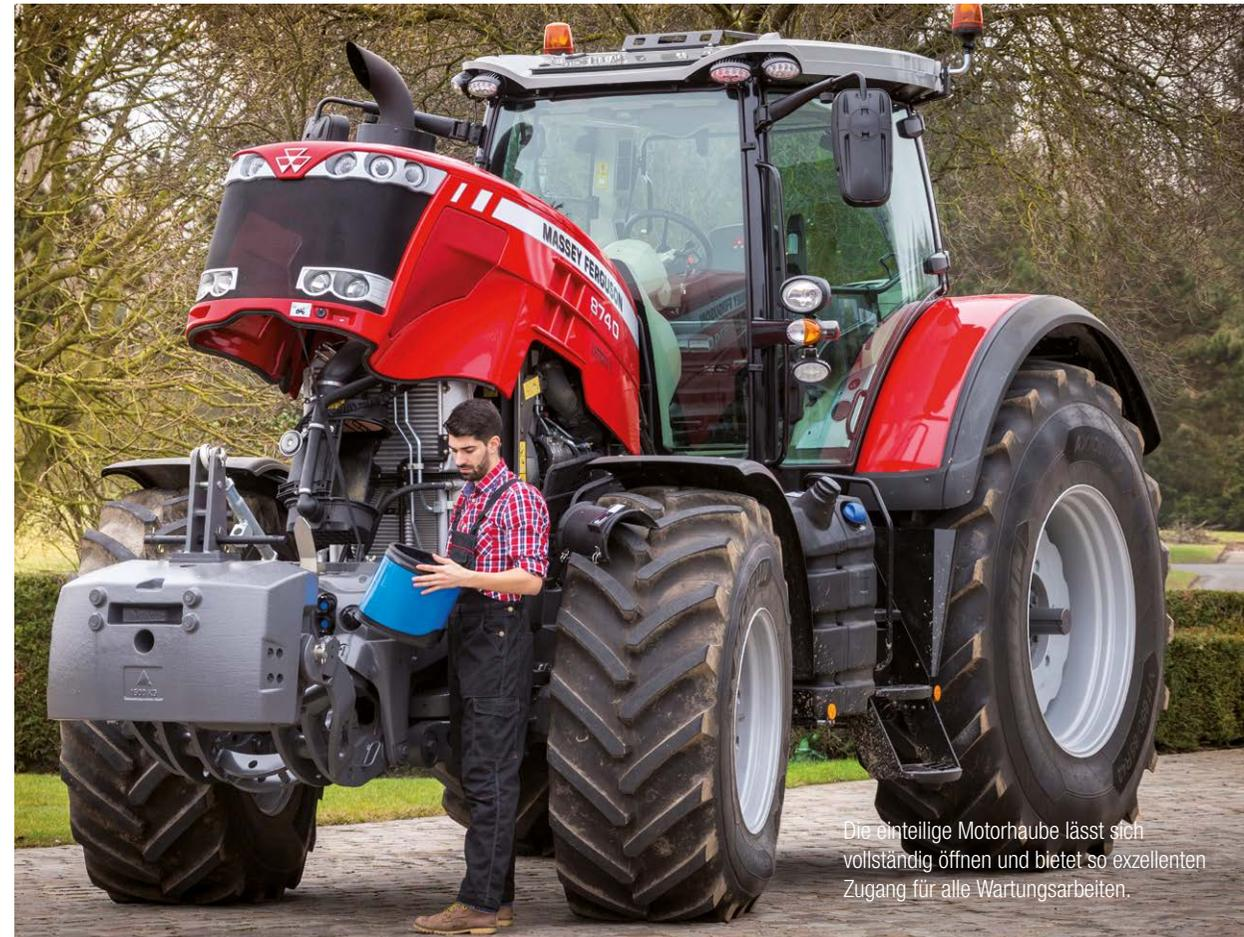
Die einteilige Motorhaube lässt sich vollständig öffnen und bietet so exzellenten Zugang für alle Wartungsarbeiten.
