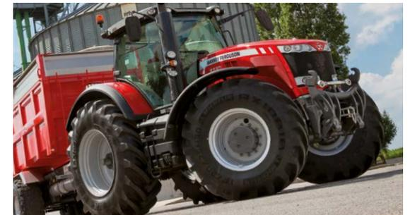
Ein einfaches und intelligentes System zum Wegklappen des Fronthubwerks verringert die Gesamtlänge des Traktors, wenn das Fronthubwerk nicht benötigt wird, wie beim Transport.
