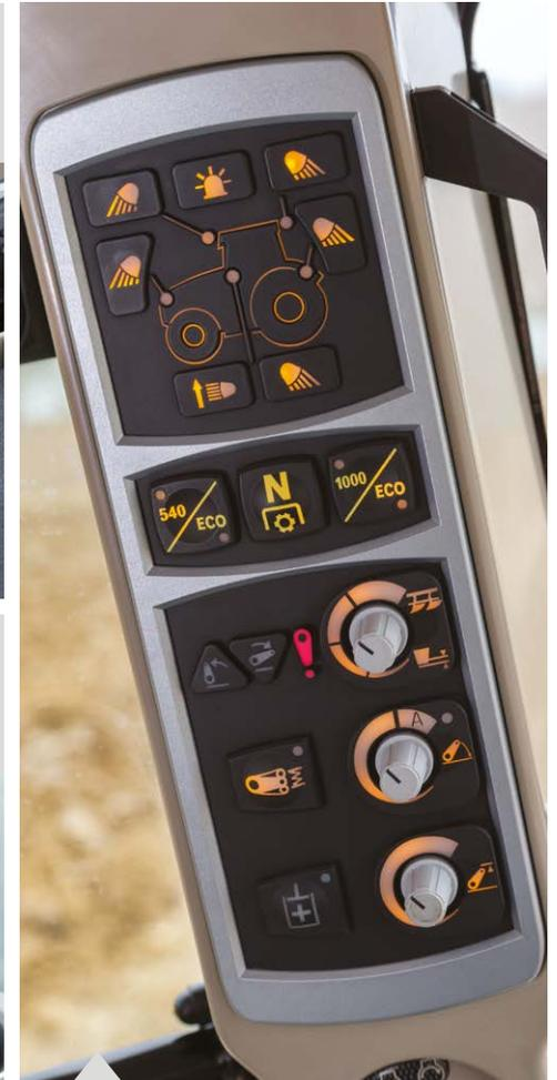
Bedienelemente für Zapfwelldrehzahl und EHR Einstellungen in der Kabinensäule.
