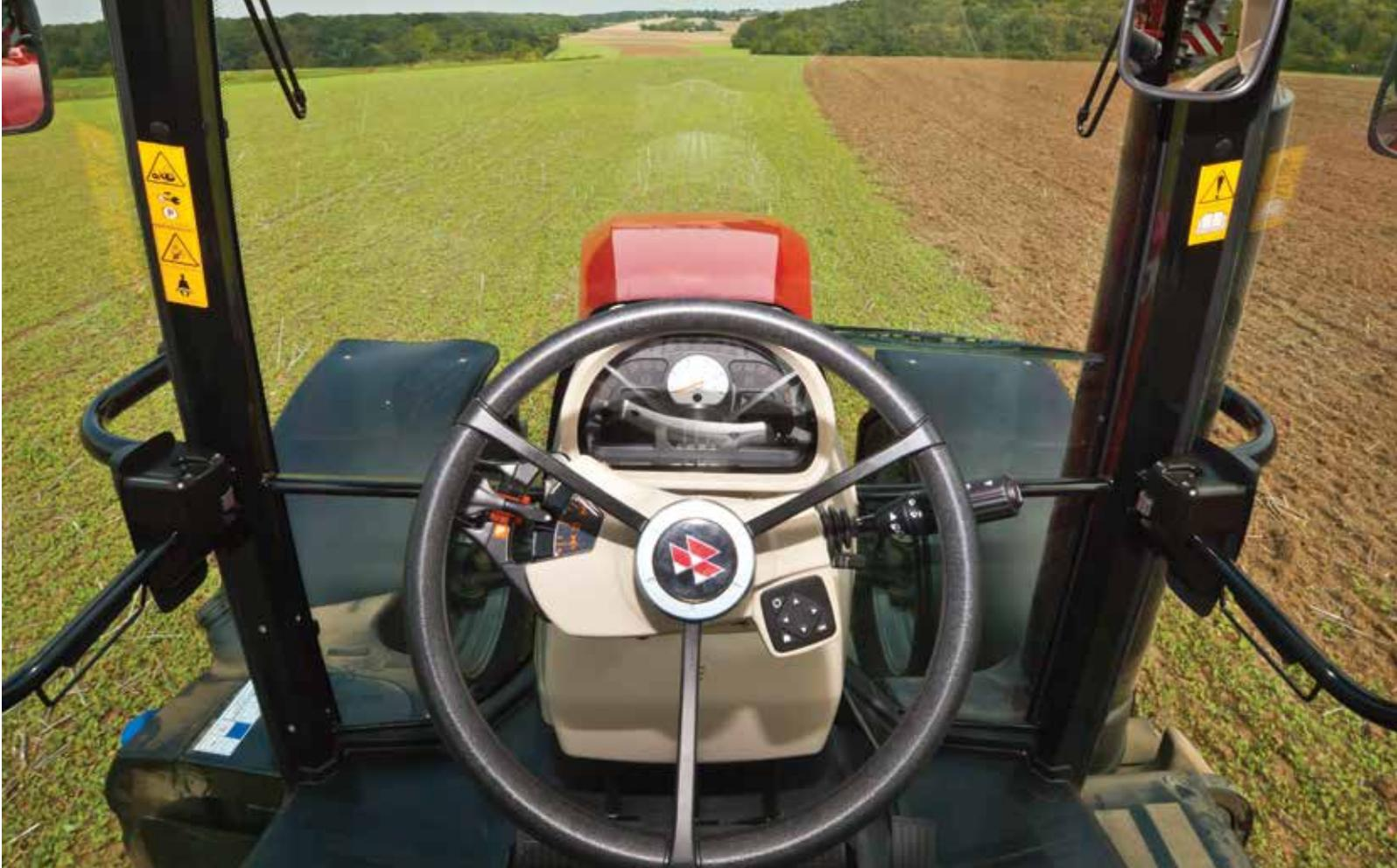
Ein überarbeitetes Kabinendesign bietet Ihnen ausgezeichnete Rundumsicht. Die Kombination aus optimal positioniertem Auspuff, schlanker Motorhaube und großen Glasflächen gewährleistet eine überragende 360°-Sicht. Die ungehinderte Sicht durch das Heckfenster sorgt nicht nur für Sicherheit, sie gewährleistet auch, dass Sie die Anbaugeräte stets im Blick haben.
