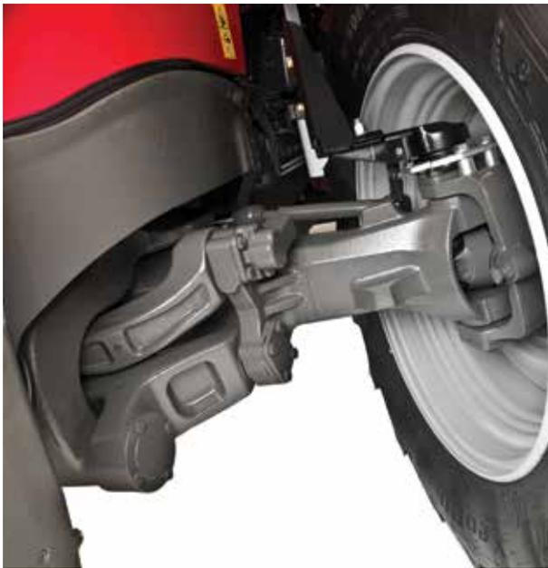
Die gefederte „QuadLink“-Vorderachse von MF steigert den Fahrkomfort und die Fahrsicherheit noch zusätzlich. Die kompakte und einfache Achskonstruktion behält, unabhängig von der Achslast, eine konstante Aufhängungshöhe bei.
