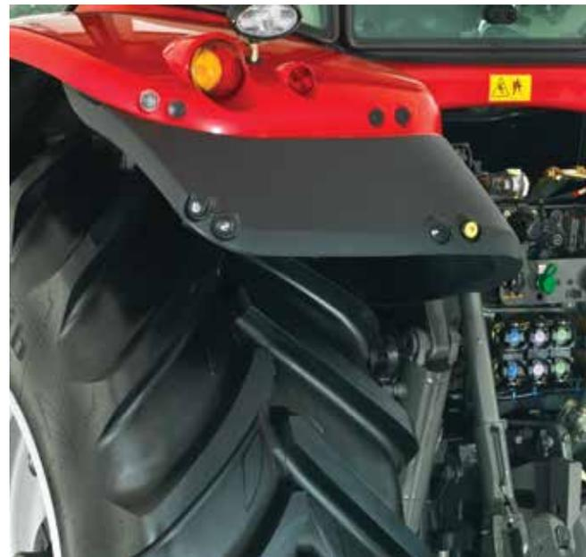
Zusätzliche, auf den Kotflügeln montierte Zapfwellen Start/Stop-Tasten ermöglichen die Bedienung der Zapfwelle auch außerhalb der Kabine. Sie können auch die Motordrehzahl mithilfe der Zapfwellen Start/Stop-Tasten regeln, eine Funktion, die beispielsweise beim Arbeiten mit einem Güllewagen äußerst hilfreich ist.
