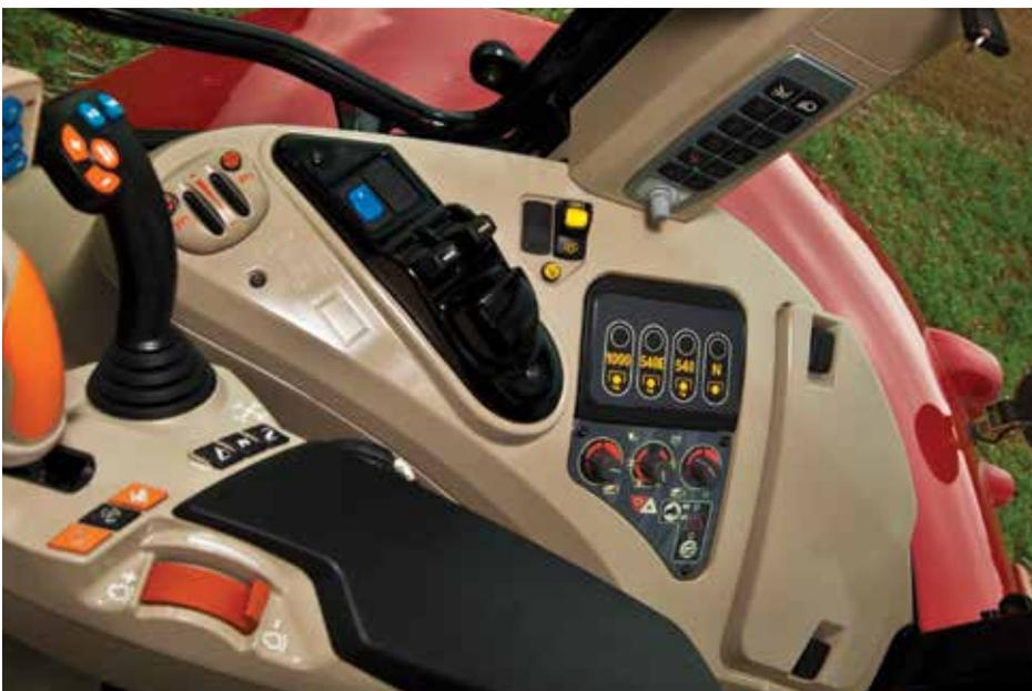
Die Schalter für die Zapfwelldrehzahl, die Zapfwellenanwahl und den Auto-Modus sind für den Fahrer gut zugänglich auf der rechten Konsole angebracht.
