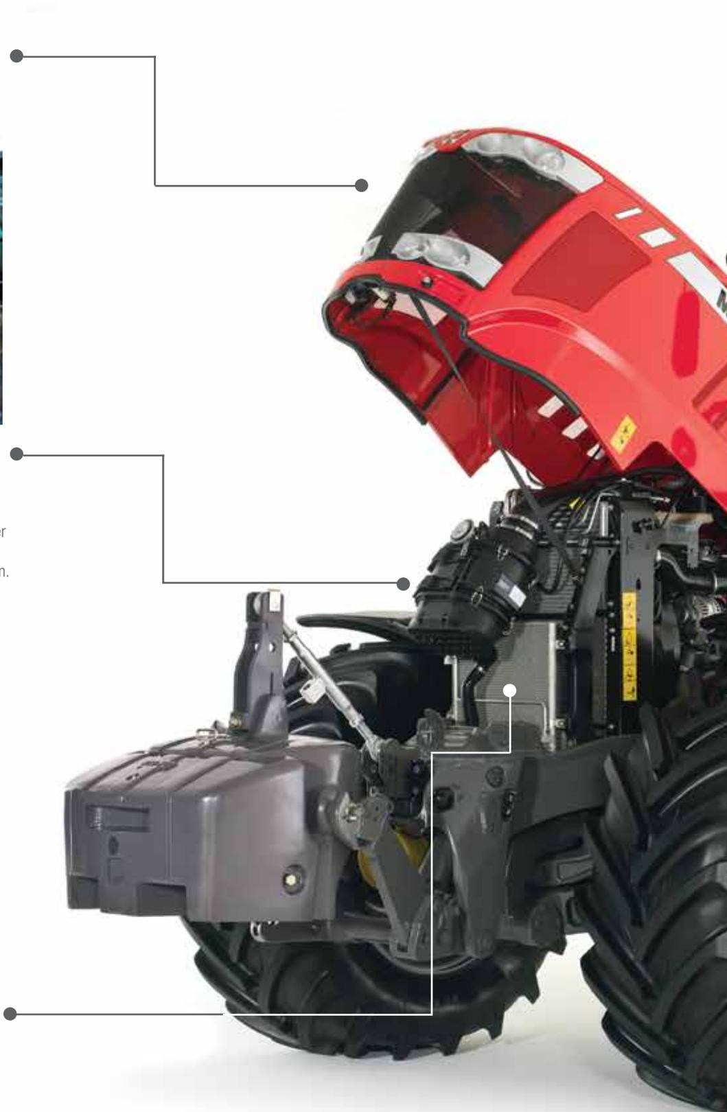
Die Wartung ist unkompliziert und einfach, so wird der Service Ihres Traktors nicht zur Belastung und Ihnen bleibt mehr Zeit für die Arbeit auf dem Feld. Durch die um 25 % auf 500 Stunden verlängerten Wartungsintervalle reduzieren sich zudem die Wartungskosten erheblich.
