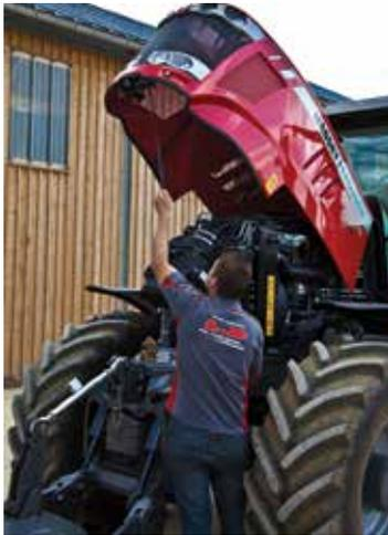
Die kompakte Kühleinheit ist bequem zugänglich, einfach zu reinigen und zu warten. Durch die Saugwirkung der Kühlgebläse wird der Staub zu 90 % auf natürliche Weise bereits vor dem Luftfilter entfernt. Der Luftfilter des Motors ist bequem zugänglich und leicht zu reinigen.
