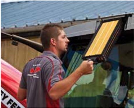
Der Kabinenluftfilter kann zur Reinigung einfach entnommen werden.
