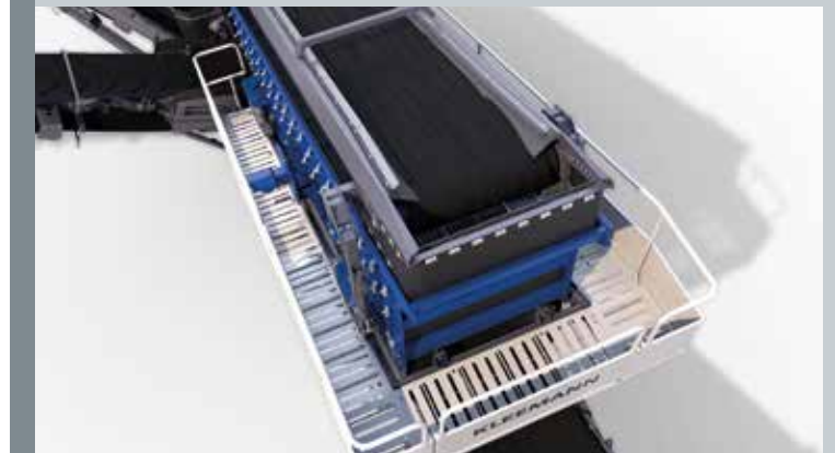
Sortie par une plate-forme de travail autour du crible
