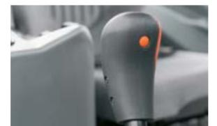
Con equipamiento REVERSHIFT y TWINSHIFT: Manejo del embrague electrónico pulsando un botón en la palanca de cambios.
