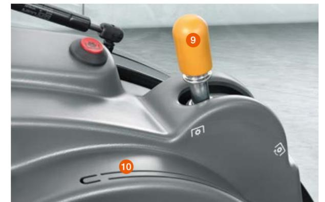
La toma de fuerza es conmutada hidráulicamente de serie. En máquinas con equipamiento REVERSHIFT se ofrece opcionalmente la conmutación electrónica de la toma de fuerza.
