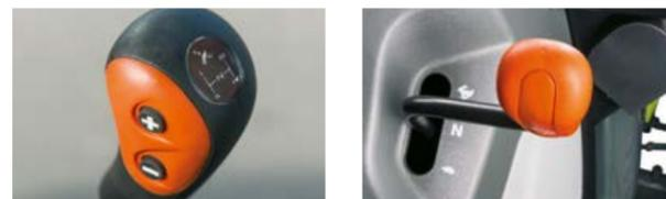
Para la caja de cambios de 24 marchas existe opcionalmente un doblador mecánico a la derecha del volante o la conmutación de carga TWINSHIFT, que se maneja con la palanca de cambio de marchas.
