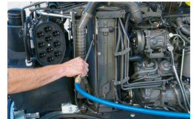
Gracias al capó monopieza del motor, se abre a su disposición al completo el espacio del motor con una sola maniobra. El filtro de aire queda directamente accesible. En un momento se puede sacar el radiador y retirar el filtro del mismo. Con la herramienta sopladora especial suministrada se facilita en gran medida la limpieza de los radiadores que se encuentran muy pegados. Así se controlan y se limpian rápidamente las superficies del radiador, cuando es necesario.
