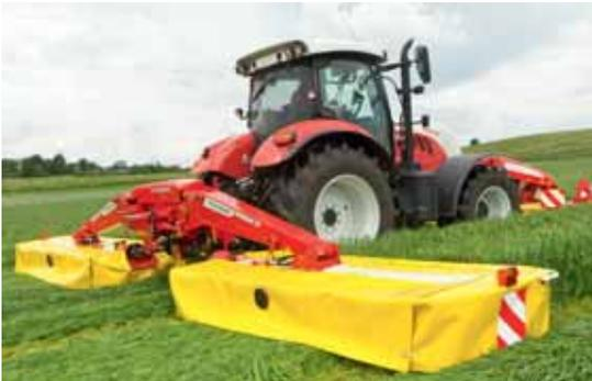
**Pöttinger définit de nouvelles normes en matière de performance et d'efficacité. La NOVACAT S12 est la plus large combinaison de fauche portée à fixation pendulaire du marché. Le nouvel "économiseur de carburant" vous offre une largeur de travail de 11,20m avec seulement 160 ch de puissance nécessaire et ainsi une faible consommation en carburant. Pour la NOVACAT S10, 130 ch suffisent.**
