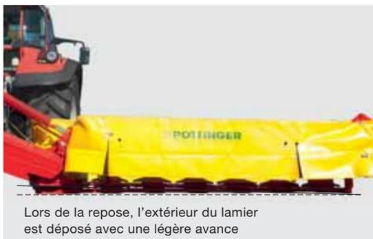
Lors de la repose, l'extérieur du lamier est déposé avec une légère avance
