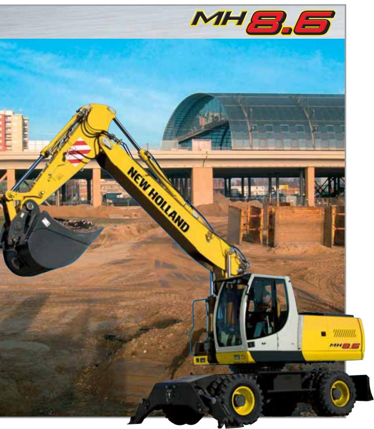
NENNLEISTUNG129 kW - 175 PSEINSATZGEWICHT (MAX.)22700 kgLÖFFELINHALT (SAE)0,50 - 1,20 m³
