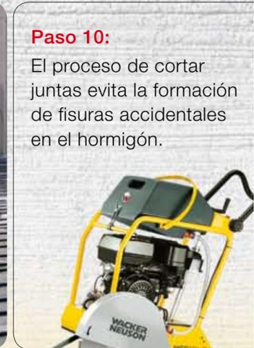
**Paso 10:** El proceso de cortar juntas evita la formación de fisuras accidentales en el hormigón.
