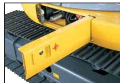
A caixa de ferramentas de grandes dimensões proporciona muito espaço. Também há espaço de arrumação para a bomba de lubrificação.
