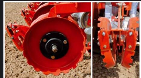
**V-Andruckrolle mit gezacktem oder glattem Rand** für tonige und steinige Böden. Sie schließen die Rille und drücken gleichzeitig das Korn an.
