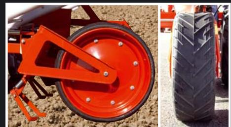
**OTIFLEX-Andruckrolle** mit Zustreichern für sandige, sehr gut bestellte Böden. Die Zustreicher schließen die Rille, die Rolle sorgt für die Rückverfestigung.
