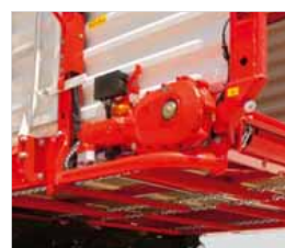
Dvourychlostní hydromotor podlahového dopravníku
