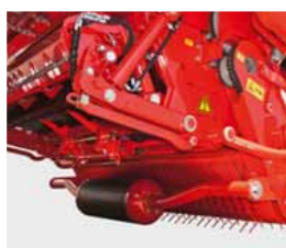
Přídavný opěrný váleček sběrače
