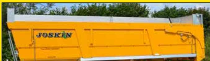
Combinatie van hydraulisch opzetschotten en één hydraulisch stalen opzetschott (50 cm)
