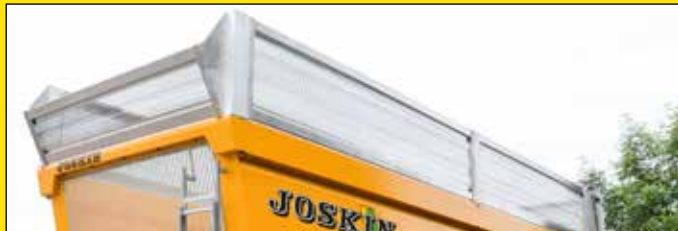
Opzetschotten type "silage" met rooster
