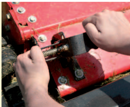
De kneuzerplaat is in drie verschillende standen verstelbaar, zodat u met de juiste instelling altijd het gewenste kneuseffect bereikt.
