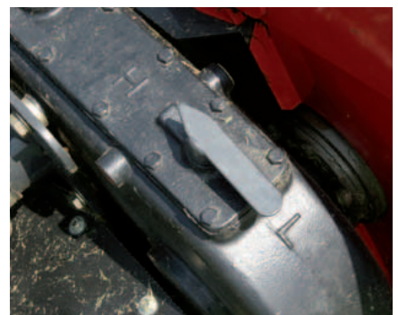
Eenvoudig schakelen van toerental van de kneuzer tussen 600 of 900 tpm.
