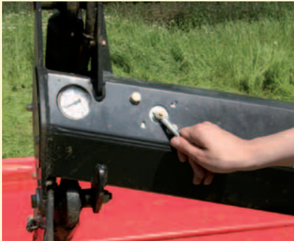
Hydraulische bodemdrukinstelling - voor een exacte en eenvoudige instelling van de bodemdruk.
