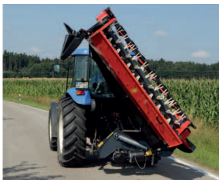
EXTRA 624T, 628T en 632T Farmer zijn compact gevouwen in een 125° doorgeklapte transportpositie.
