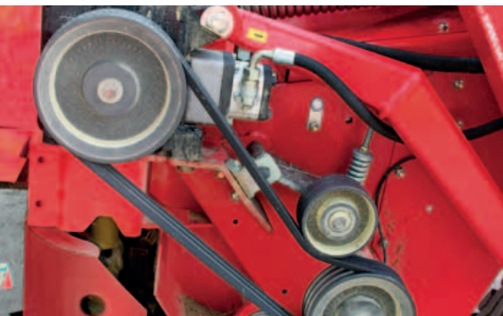
De kneuzer wordt aangedreven door 3 V snaren (m.u.v. EXTR \Delta 632T Pro), voor een soepele en stille aandrijving van de rotor.
