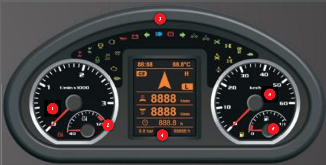
1 Drehzahlmesser, 2 Motortemperatur, 3 Kontrollleuchten, 4 I.B.C.-Display, 5 Tankanzeige, 6 Geschwindigkeit
