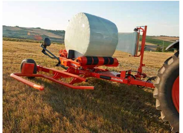
Piattaforma con due rulli a rotazione attiva pensati per la massima stabilità della balla e rotazione regolare e uniforme.
