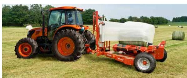
Il posizionamento basso della piattaforma permette velocità di rotazione maggiore.
