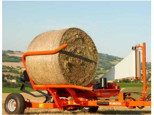
Il braccio di carico idraulico con un'ampia apertura verso il basso facilita il carico rapido della balla.
