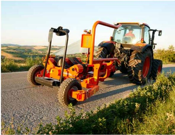
Nel passaggio tra strada e lavoro, il braccio di carico aiuta il posizionamento della ruota spingendo verso il suolo e alzando l'attrezzo.
