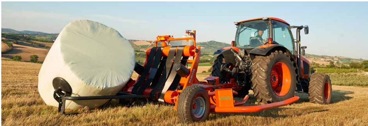
Il Kubota può montare un kit di rotazione sul lato piatto delle balle allo scarico che le accompagna delicatamente senza danneggiare il film.
