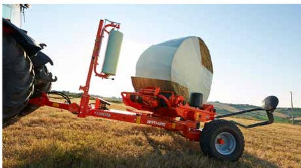
Il design ultrabasso della macchina assicura uno scarico rapido e delicato senza il bisogno di un dispositivo per attutire il salto.
