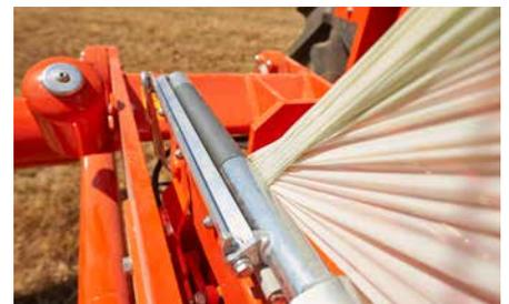
Dispositivo idraulico per il taglio del film.
