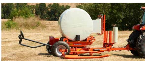
Il braccio di carico con fine corsa e supporto interno registrabile permette di raccogliere la palla in movimento e caricarla.
