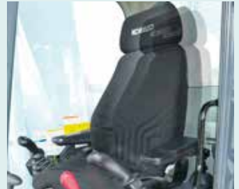
Doppel-Führungsschienen ermöglichen die Einstellung für optimalen Komfort
