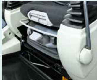
Die Sitzfederung absorbiert Vibrationen
