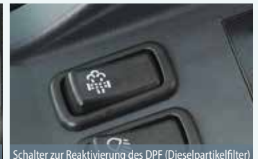
Schalter zur Reaktivierung des DPF (Dieselpartikelfilter)
