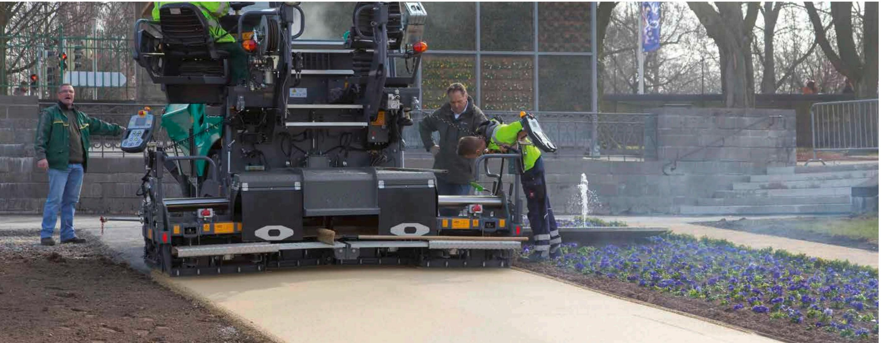
**DIE AB 340 TV** ist die perfekte Einbaubohle für den SUPER 1303-3i. Sie verfügt über eine Grundbreite von 1,80 m und ist hydraulisch bis auf eine Breite von 3,40 m ausfahrbar. Mit Verbreiterungen lässt sie sich bis auf eine maximale Einbaubreite von 4,50 m erweitern.
