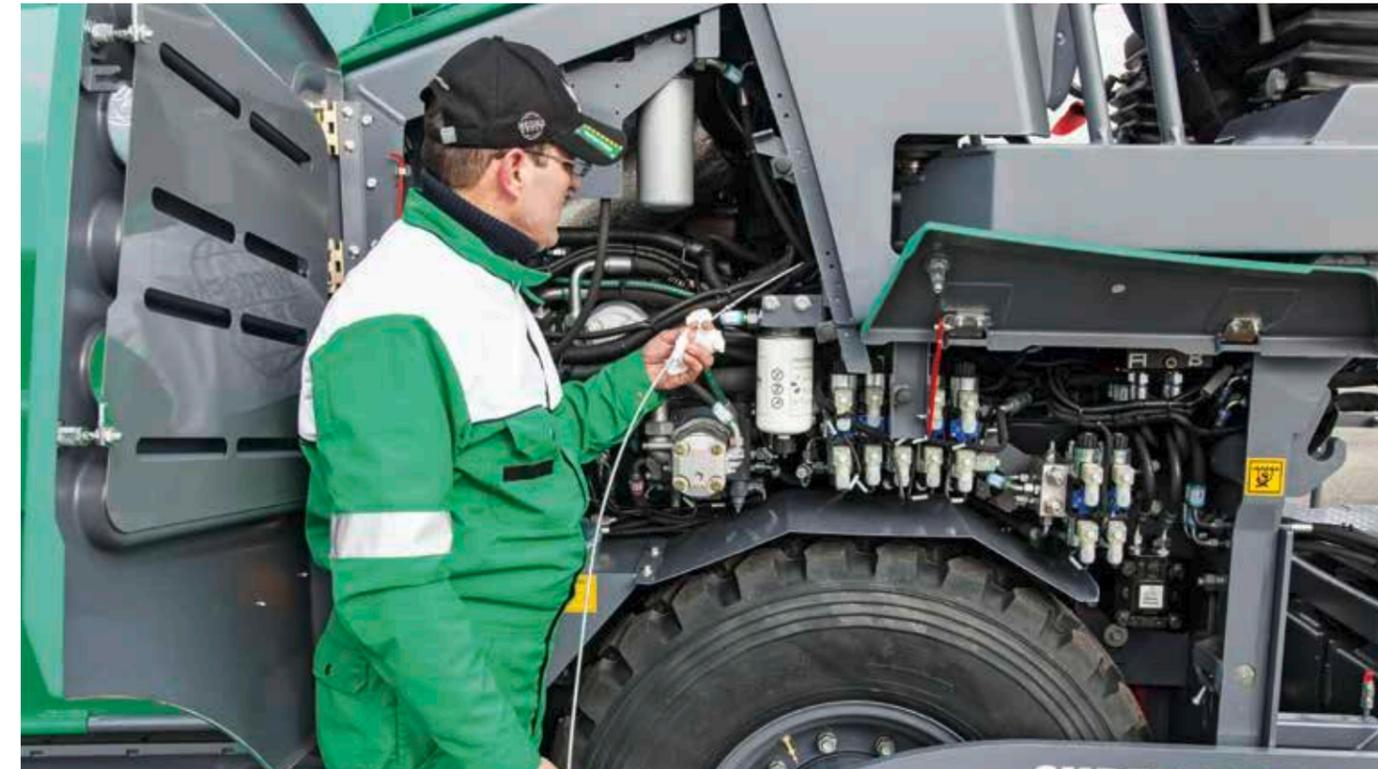
Das einheitliche Servicekonzept der „Strich 3“- Fertiger ermöglicht eine schnelle, unkomplizierte Wartung. Alle Servicepunkte an der Maschine sind mittels großer Wartungsklappen leicht zugänglich.
