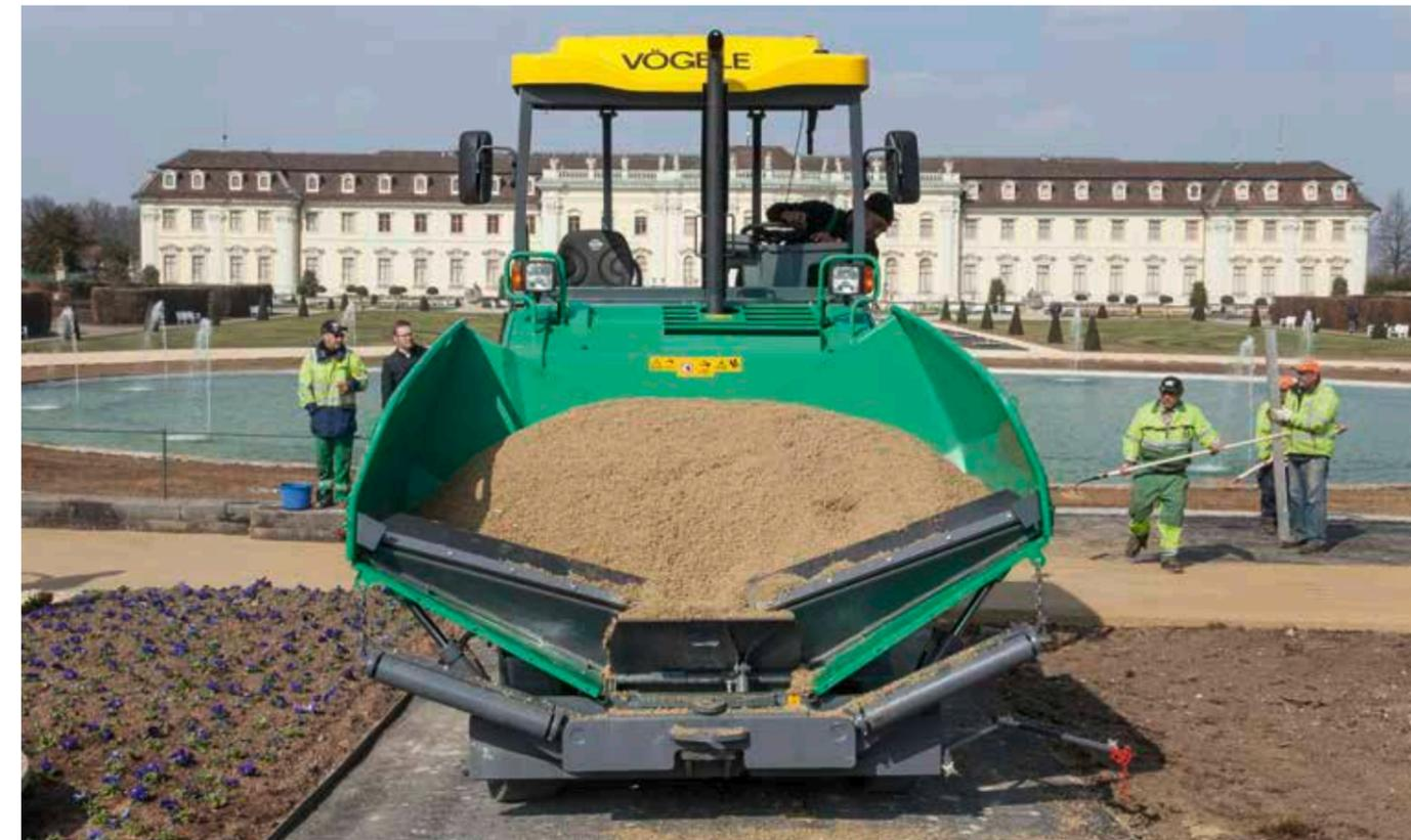
Trotz der **schmalen Silhouette** des Fertigers fasst der Aufnahmebehälter 10 t. Die hydraulische Behälterfrontklappe unterstützt die Beschickung wie auch die Entleerung des Behälters. Für das ruckfreie Andocken von LKWs besitzt der Fertiger pendelnd aufgehängte LKW-Abdruckrollen.
