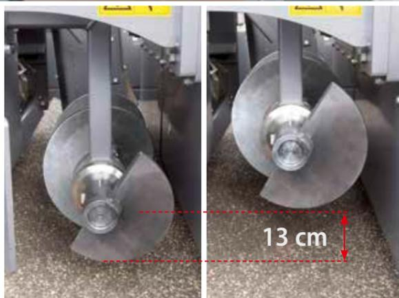
Der Weitertransport des Materials und die gleichmäßige Verteilung vor der Bohle ist dank des großen Materialtunnels, der proportional regelbaren Kratzerbänder sowie der leistungsstarken Verteilerschnecke optimal. Schneckenhöhenverstellung und klappbare Kanalbleche ermöglichen zudem ein Umsetzen ohne zeit- und kostenintensive Umbauarbeiten.
