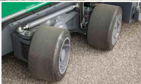
**Stark beim Einbau**, komfortabel auf der Straße: Das präzise Lenk- und Fahrverhalten sorgt für eine ausgezeichnete Manövrierfähigkeit des SUPER 1303-3i, die auch Ausdruck findet in einem Außenwenderadius von nur 4,90 m (3,80 m mit Pivot Steer). Mit dem traktionsstarken Antrieb kann der Fertiger zügig einbauen und mit maximal 20 km/h im öffentlichen Straßenverkehr fahren. Wenn der nächste Einsatzort in der Umgebung liegt, ist somit ein Transport mittels Tieflader überflüssig.
