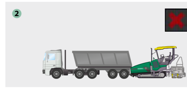
Parar: el camión tiene que detenerse. El camión está acoplado.
