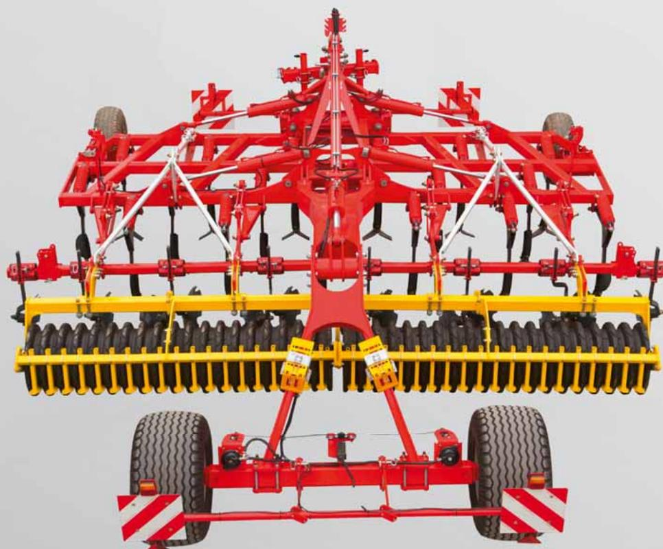
Timon et chariot de transport se montent ultérieurement sur un outil porté repliable.
