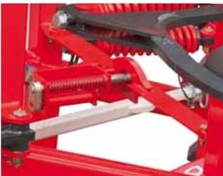
Verrouillage mécanique à commande hydraulique
