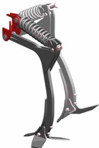
PÖTTINGER a modifié intégralement sa sécurité NOVA. Elle est équipée d'un nouveau montage à ressort, disposé à l'horizontale. De plus, les disques de nivellement sont également montés sur boudins caoutchoucs. Cela garantit un déclenchement fiable et protège les disques et paliers.
