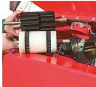
Einfacher Wechsel von Grob- auf Feindosierrad
