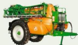
Pulvérisateur UX, 3200 - 4200 - 5200 - 6200 - 11200 litres, 15 à 40 m
