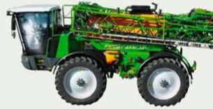
Pulvérisateur automoteur Pantera, 4000 litres, 24 à 40 m
