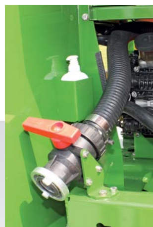
Feltöltés külső nyomóvezetékéről („C” vagy Kamlok rendszerű csatlakozó)
