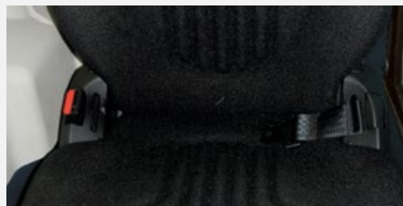
ремень безопасности с преднатяжным устройством
