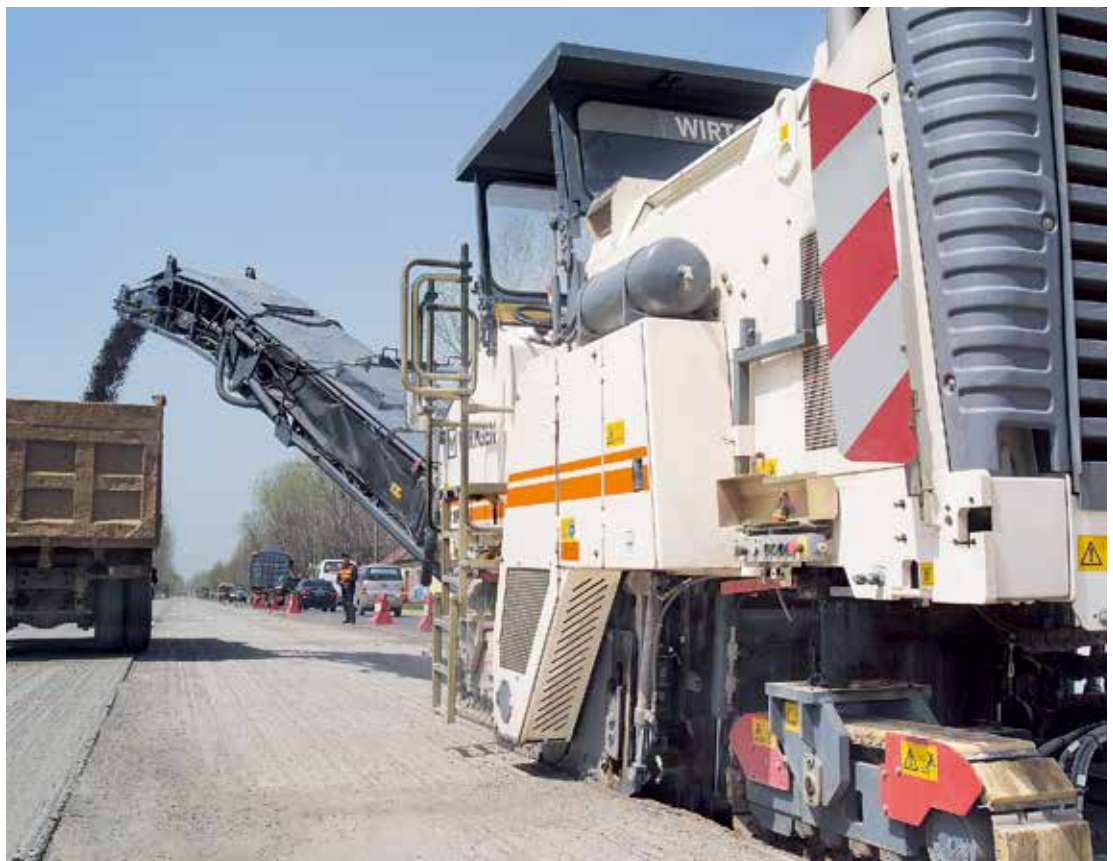
得益于强大的输料系统，W 1900 型冷铣刨机可容易地清理施工现场。
