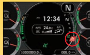
Jauge du niveau de liquide AdBlue® et assistance au remplissage
