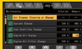
Écran de base de maintenance
