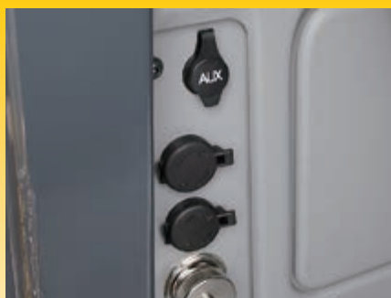
Entrée auxiliaire (fiche MP3) et deux ports d'alimentation de 12 volts
