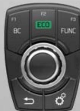
**Funcionalidad orientada al futuro:** como ocurre en el sector automovilístico, el modo de operación de la excavadora móvil EW100 dispone de un concepto completamente nuevo en cuanto a la ergonomía y al manejo intuitivo. Mediante el sistema de disco selector pueden controlarse directamente todas las funciones centrales, sin que el operador deba buscar distintos interruptores, lo que aporta una mayor seguridad y confort.
