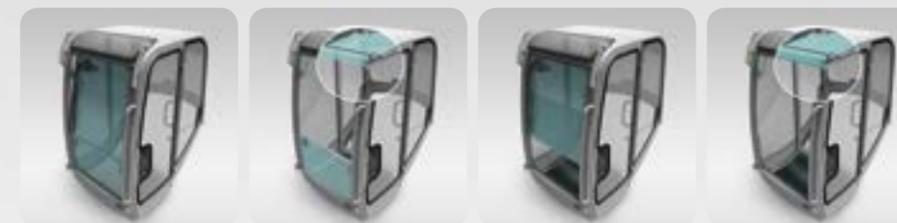
**Abertura innovadora para el trabajo diario.** El novedoso sistema de apertura del parabrisas facilita la ventilación de la cabina y la comunicación con el conductor. Retirar el parabrisas y guardarlo es solo un recuerdo del pasado.
