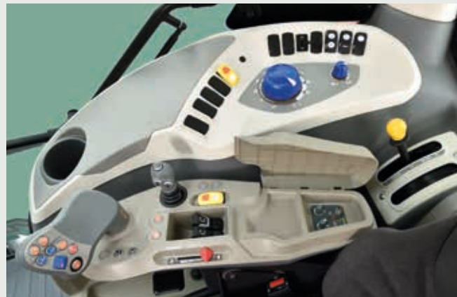
Kabineninterieur mit VT-Drive Getriebe: Die Bedienelemente sind in der rechten Armlehne des Fahrersitzes integriert.
